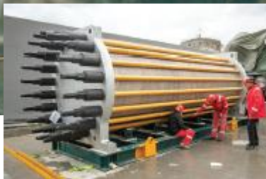
33 idrolizzatori da 5,3 MW
